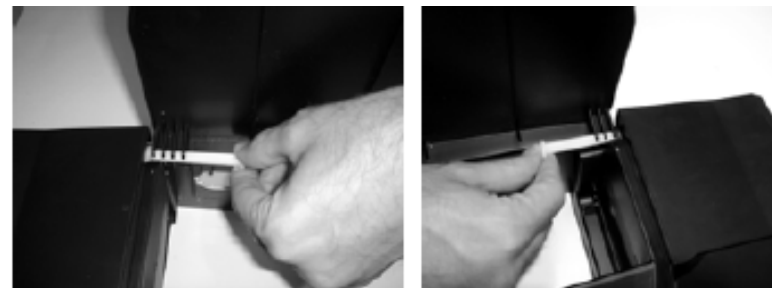
Рисунок 19: Установка крышки флотатора
