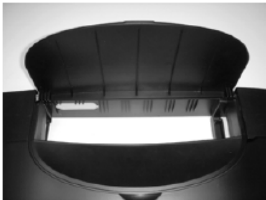
Рисунок 18: Установка крышки флотатора
